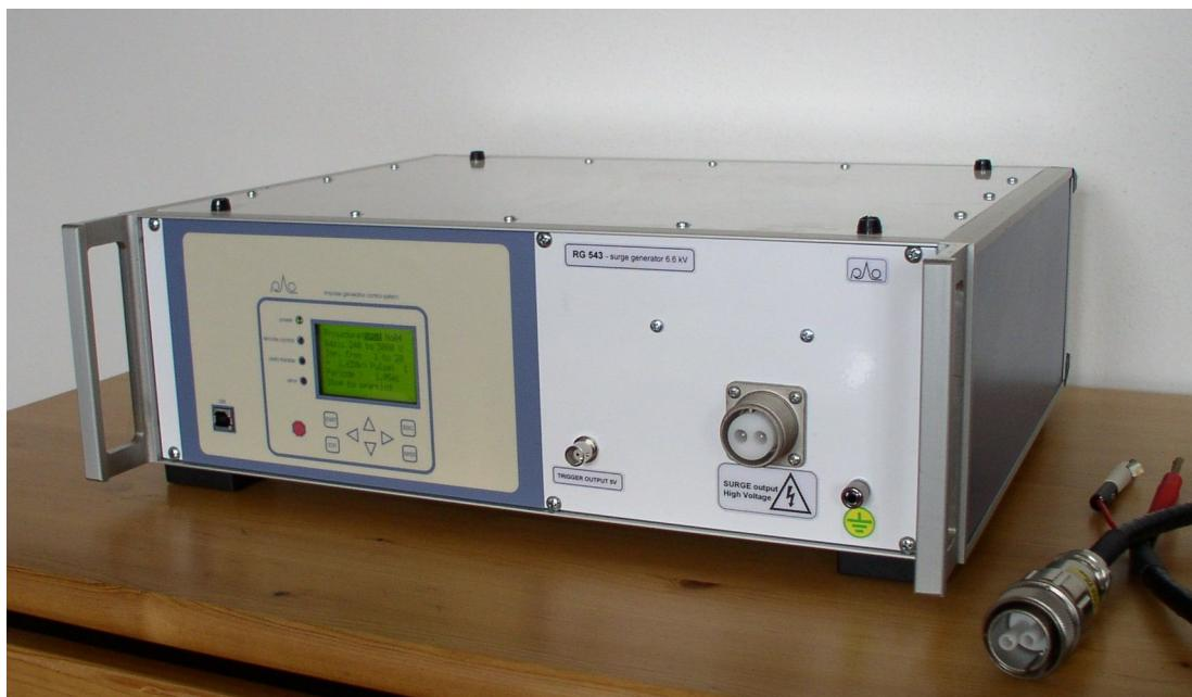
Generátor impulsu napětí 1.2/50  $\mu$ s je určen k testům odolnosti izolace elektronických zařízení vůči účinkům impulsních přepětí, která vznikají při atmosférických výbojích nebo při spínání velkých výkonů. Provádění testů je stanoveno normou ČSN EN 61180.
