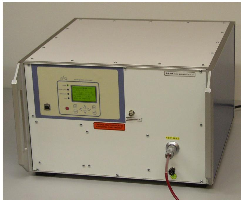
Generátor impulsu napětí 1.2/50  $\mu$ s je určen k testům odolnosti izolace elektronických zařízení vůči účinkům impulsních přepětí, která vznikají při atmosférických výbojích nebo při spínání velkých výkonů. Provádění testů je stanoveno normou ČSN EN 61180.
