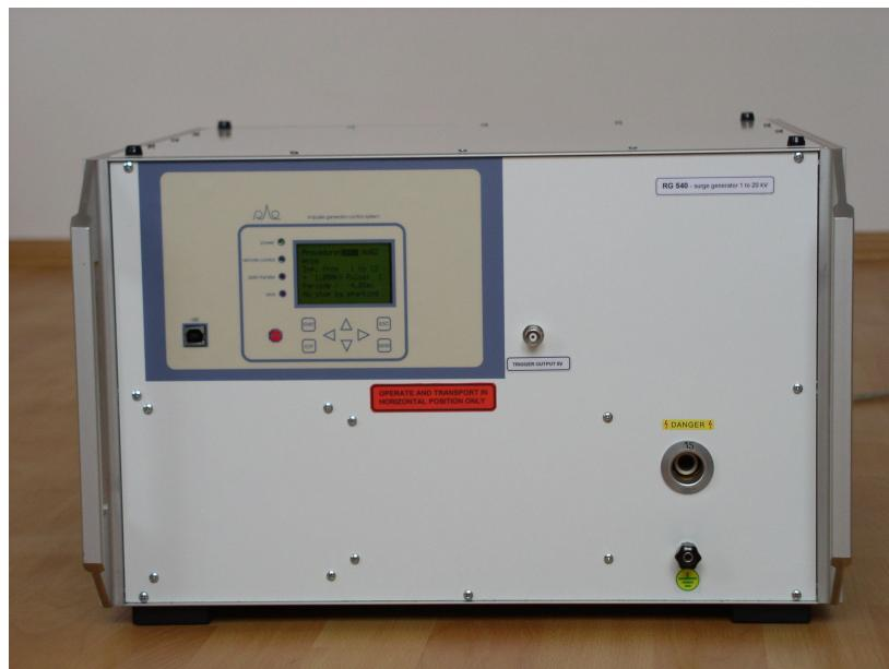
Generátor impulsu napětí 1.2/50 µs je určen k testům odolnosti izolace elektronických zařízení vůči účinkům impulsních přepětí, která vznikají při atmosférických výbojích nebo při spínání velkých výkonů. Provádění testů je stanoveno normou ČSN EN 61180.
