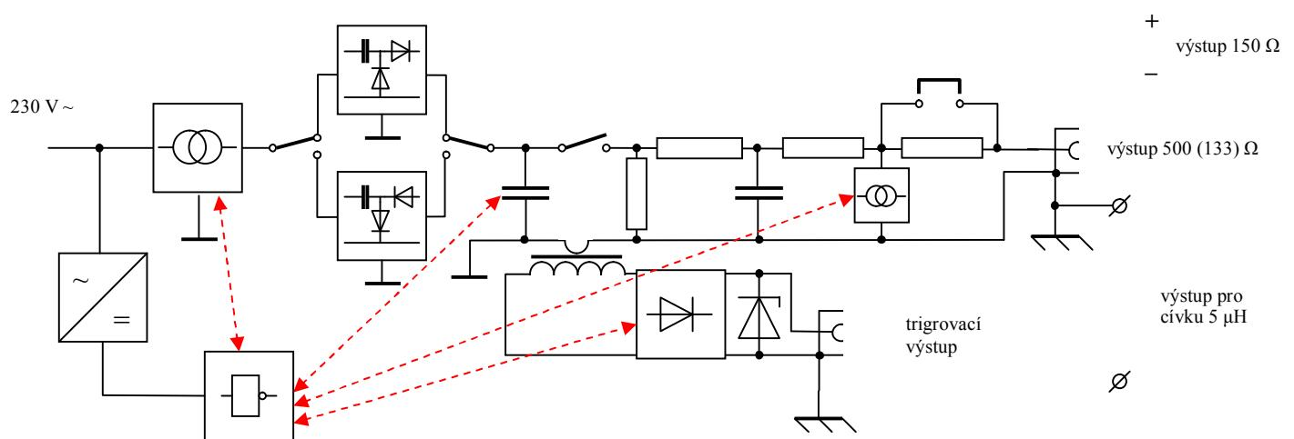
Obr. 1 - zjednodušené silové schéma generátoru RG 540
